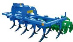
ЧИЗЕЛЬНЫЙ ПЛУТ С АВТОМАТИЧЕСКИМИ ПРУЖИНАМИ
