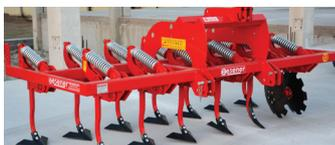
КУЛЬТИВАТОР ГОРИЗОНТАЛЬНОГО РЕССОРНОГО ТИПА
